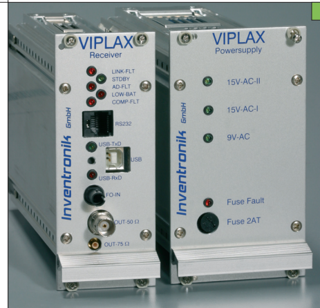
VIPLAX-Empfänger mit Netzgerät
